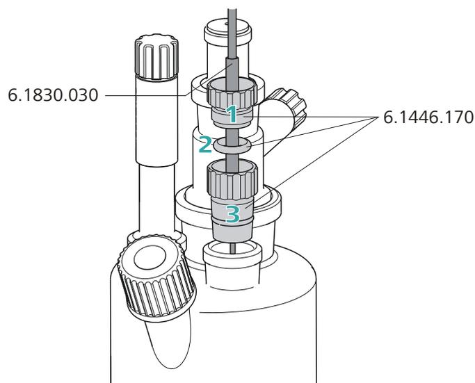
Figure 14 Coulometric KF titration cell
